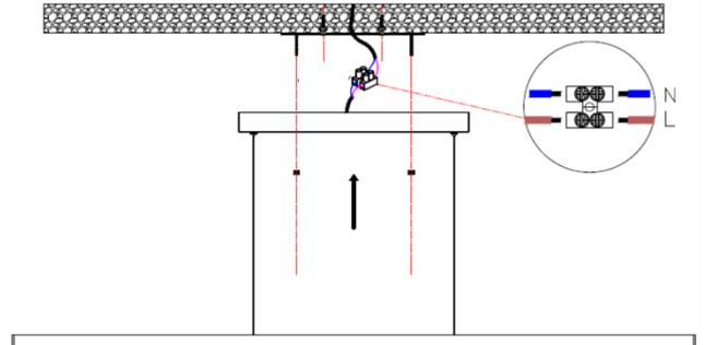
2. Realice las conexiones a la línea eléctrica (Cable azul neutro, cable café línea). Arme el canope y ajuste el largo de los cables según lo deseado (Puede guardar el excedente de cable dentro del canope).
