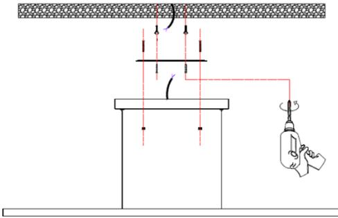
1. Apague la energía eléctrica. Fije la tapa del canope al techo usando pijas y taquetes.
