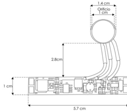
Utilizado como sensor de presencia y de iluminación ambiente con función de apagado y encendido de tiras extraplanas del tipo monocromático.
