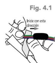
Fig. 1.2 Coloque cinta masilla en el segundo conductor, incorporando este con el primer conductor de ambos cables de alimentación eléctrica y de la luminaria.
