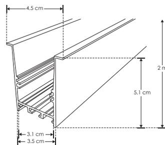
**Material** Kit de perfil de aluminio con ceja, acabado negro de empotrar de 2 m de largo, para recibir tira extraplana de LEDs o tarjeta de LEDs
