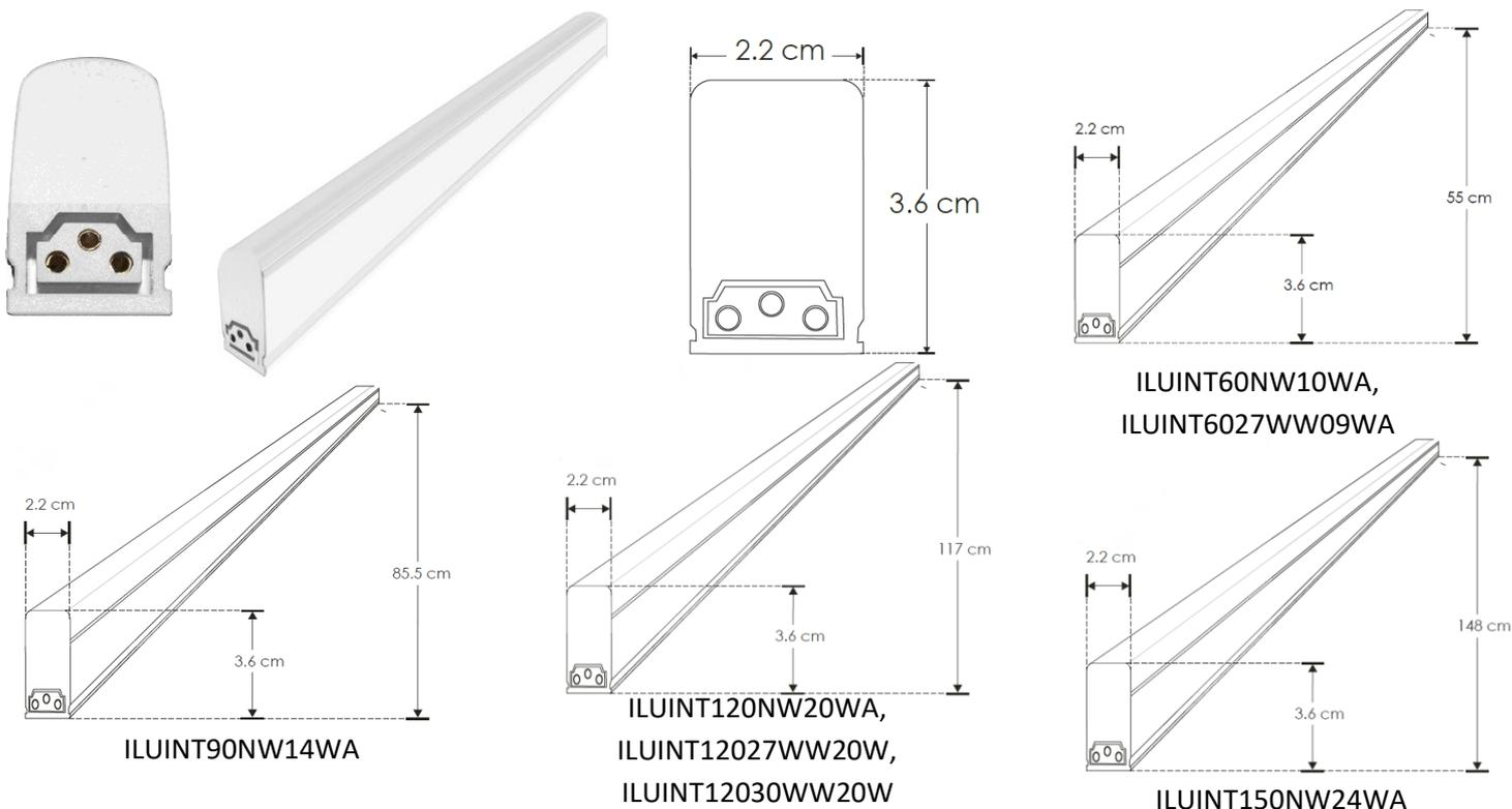
Este producto es usado como elemento de iluminación directa, indirecta en comercio residencia, muebles etc. fuente luminosa a base de leds de superficie 2835 interconectable aterrizada. Modelos con terminación A con controlador (driver) aterrizado.
