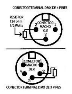
Se recomienda instalar una resistencia de 120 ohm a ½ Watt según diagrama anterior entre los pines 2 y 3 del ultimo luminario, driver o equipo DMX para evitar inducciones de ruido por medio del cable de señal que provocara fallas de falta de control.
