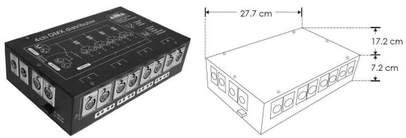
Divisor de una entrada y cuatro salidas opto aisladas (cada una con conector XLR 3 y 5 pines). Utilizado para aislar señales DMX desde un controlador o interfaz hacia equipos DMX remotos.
