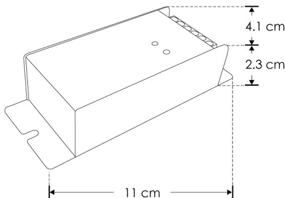
Utilizado para atenuar con dimmers (atenuadores) analógicos de 0-10 V tira de led extraplana del tipo Monocromático. Compatible con sistemas inteligentes.
