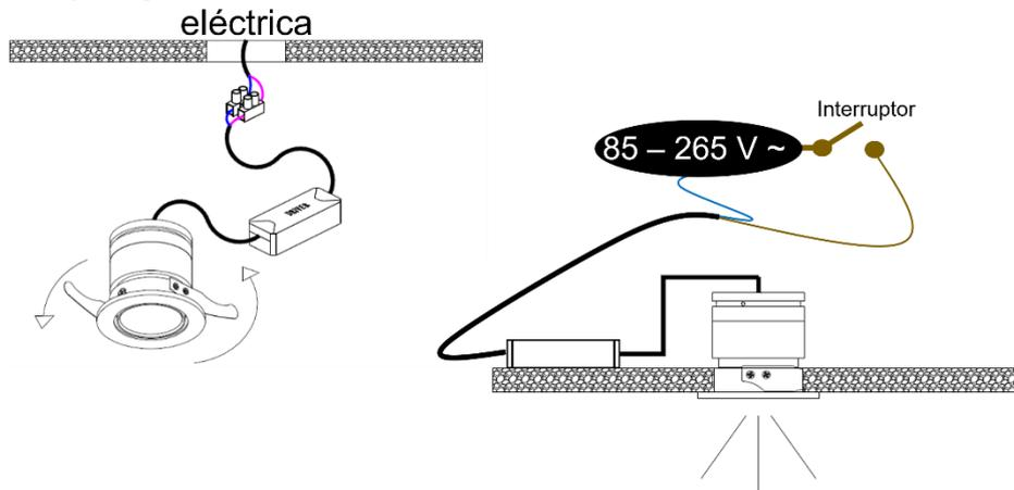
3. Inserte el luminario y asegúrelo con los soportes laterales, enciéndalo y pruebe su funcionamiento. Los modelos de 5 y 7W son dirigibles, por lo que puede ajustar el haz de luz para crear el efecto deseado.
