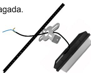
4. Pase los cables de alimentación por un orificio a través del muro y a través de la base. Conecte al luminario. Aísle perfectamente.
