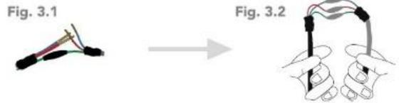
4.- Realice el aislamiento cubriendo la cinta vulcanizable desde el conductor de alimentación en dirección del cable de la luminaria.
