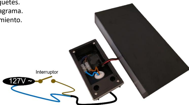
Para instalación en exteriores se recomienda usar el siguiente método de aislamiento:
