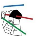
Fig. 1.1 Coloque cinta masilla al primer conductor tanto de alimentación como al de la luminaria.
