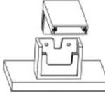
3. Inserte el luminario en la base pasando el cable de alimentación.
