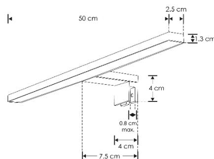
Luminario para espejos con tres tipos de instalación: sobrepuesto en pared, sobrepuesto en mueble o fijo en espejo de hasta 8mm de espesor.
