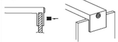
1. Inserte el luminario apoyado en el espejo y ajuste los prisioneros de plástico para que quede fijo firmemente. Conecte los cables de alimentación eléctrica.
