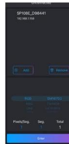
8. Una vez enlazado el controlador, selecciónelo y presione ENTER para comenzar a cambiar los efectos luminosos en la tira de LED.
