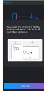
7. Mantenga presionado el interruptor AP/STA del controlador, una vez que el led indicador parpadee en color verde, presione CONTINUAR
