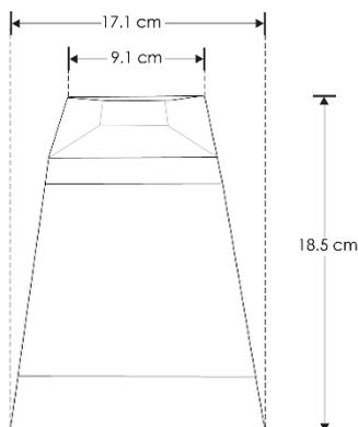
Luminario tipo bolardo, es usado como elemento de iluminación en jardines, patios, corredores, etc. No requiere de ningún controlador o driver externo, base E27 para lámpara con potencia máxima de 15W (No incluida).
