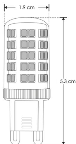
Lámpara tipo cacahuate con LED de montaje superficial para uso en interiores.
