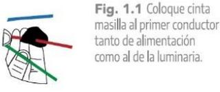
**Fig. 1.1** Coloque cinta masilla al primer conductor tanto de alimentación como al de la luminaria.
