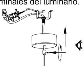
5. Asegure el cable de suspensión de acuerdo con la longitud deseada, guarde la caja de conexiones y el exceso de cable dentro del canope.
