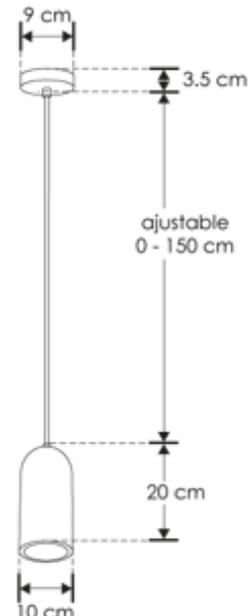
Este producto se usa como elemento de iluminación suspendido en techo (incluye canope para sobreponer), incluye base E27 (no incluye lámpara). Características de la base E27 incluida: 277 V ~ 25 W (0.2 A) máximo 50/60Hz
