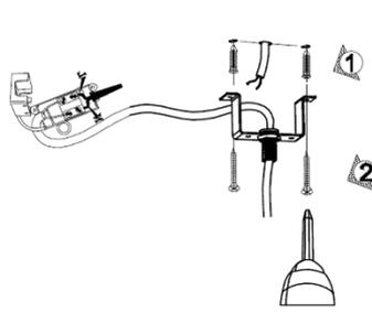
3. Pase el cable de alimentación a través del techo y conecte a las terminales del luminario.
