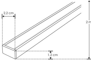
**Material** Kit de perfil de aluminio sin ceja tipo wall washer, acabado natural de sobreponer luz indirecta de 2 m de largo, para recibir tira extraplana de LEDs
