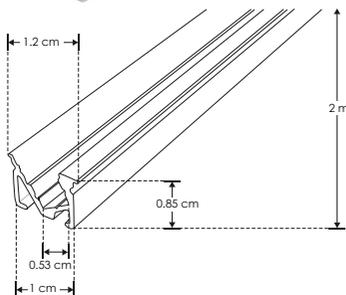
**Material** Kit de perfil de aluminio con ceja tipo wall-washer, acabado natural de empotrar en techo o pared de 2 m de largo, para recibir tira extraplana de LEDs
