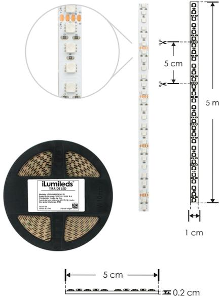
**NOTA:** Por su alta concentración de LEDs es indispensable que este producto vaya montado sobre un perfil de aluminio para disipar el calor ya que fue diseñada especialmente para perfiles de aluminio para producir un efecto uniforme de luz, no produce sombras. Requiere un controlador (No incluido) para cambio de colores.
