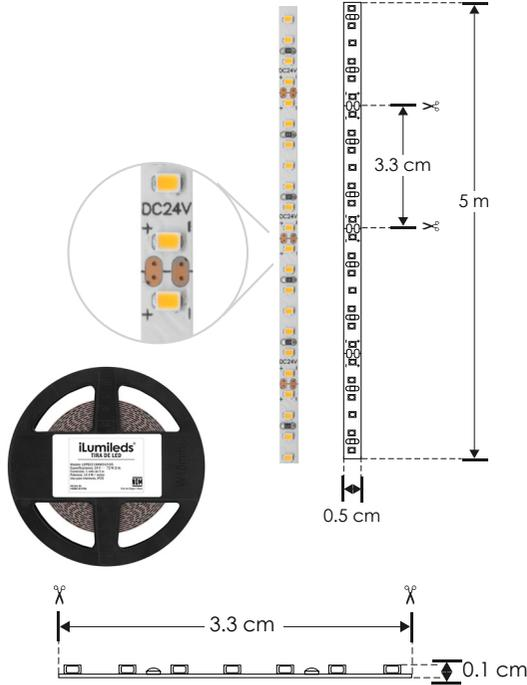
**NOTA:** LED con tono de color controlado. Por su alta concentración de LEDs, es indispensable que este producto vaya montado sobre un perfil de aluminio para disipar el calor, ya que fue diseñada específicamente para perfiles de aluminio para producir un efecto uniforme de luz, no produce sombras.
