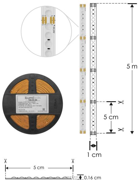
**NOTA:** RGB requiere un controlador (No incluido) para cambio de colores. LED con tono de color controlado.
