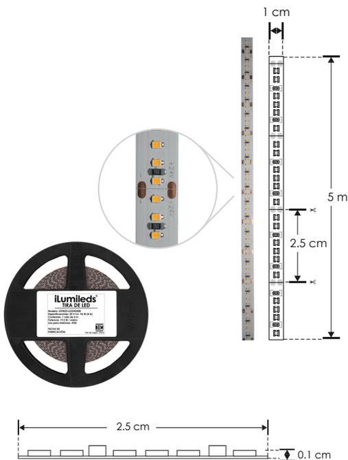
**NOTA:** LED con tono de color controlado. Por su alta concentración de LEDs es indispensable que este producto vaya montado sobre un perfil de aluminio para disipar el calor ya que fue diseñada especialmente para perfiles de aluminio para producir un efecto uniforme de luz, no produce sombras.
