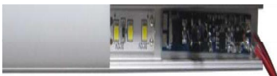
Sensor con cable de alimentación y Tira Montado sobre un perfil de aluminio
