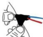
Fig. 1.2 Coloque cinta masilla en el segundo conductor, incorporando este con el primer conductor de ambos cables de alimentación eléctrica y de la luminaria.
